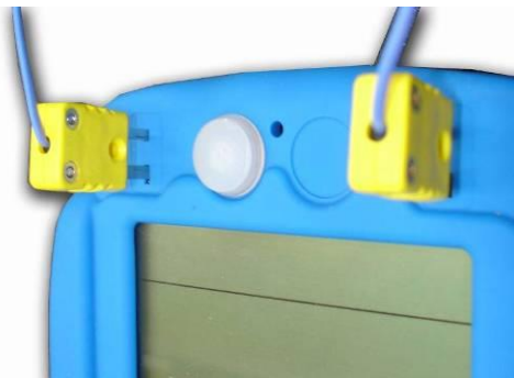
COLLEGAMENTO DELLE SONDE
